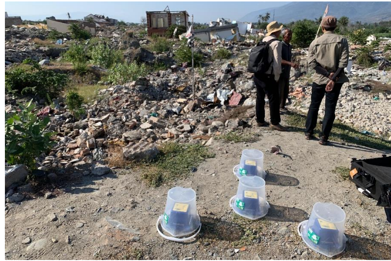
Microtremor survey at Balaroa03 (miniature array)
